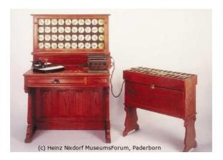
Schon als Herman Hollerith um 1890 seine berühmte Hollerith-Maschine zur Auswertung der amerikanischen Volkszählung baute, hatte er ein zusätzliches Gerät zum Sortieren der Lochkarten konstruiert. In der obigen Abbildung ist eine solche Hollerith-Maschine im Original zu sehen. Das rechte, etwas kleinere Gerät ist dabei die Lochkarten-Sortiereinheit. Im Zeitalter der Elektronik im Miniaturformat muss ein solcher Sortierer natürlich sehr viel kleiner ausfallen als Holleriths Gerät.
